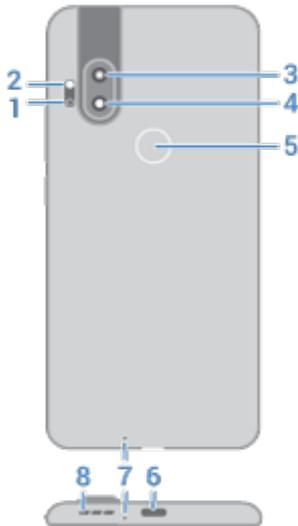
1. Capteur de mise au point automatique laser
